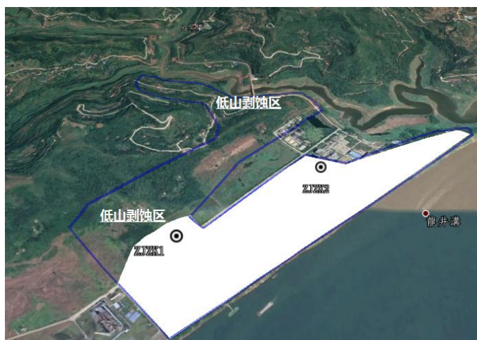
图 5.1-15 丰都工业园区镇江地块工程地质单元分区及钻孔布设（截自 GoogleEarth）
