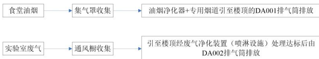
图4.2-1 食堂油烟和实验室废气处理流程图
