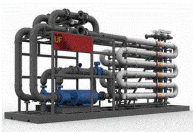
图 2-6 外置式超滤效果图
