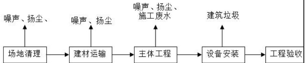
图 2.5-1 本项目施工期工艺流程及产污环节
