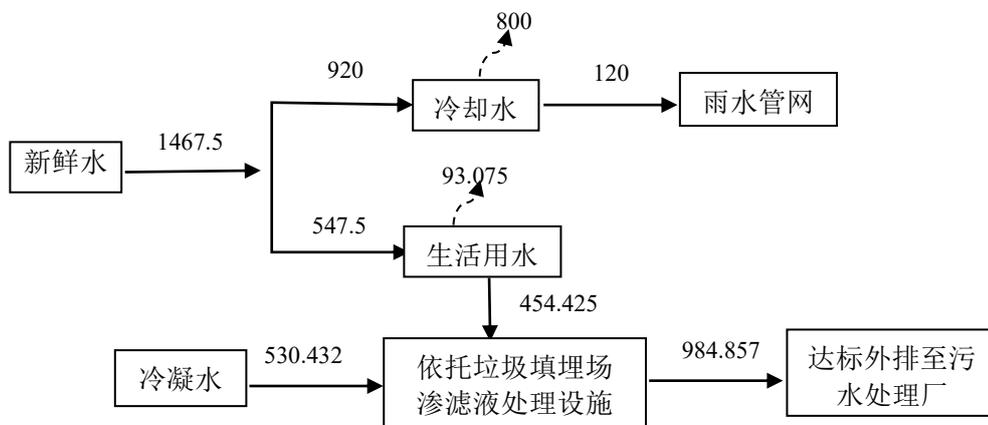
图 2.3-2 项目水平衡图 单位：m<sup>3</sup>/a
