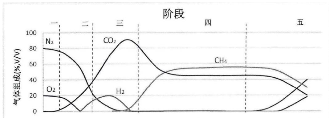
**图 2.3-1 生活垃圾填埋场产气阶段及产气曲线**
