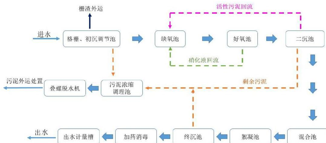
图 2.2.2-1 南天湖镇污水处理厂升级改造工艺流程图
